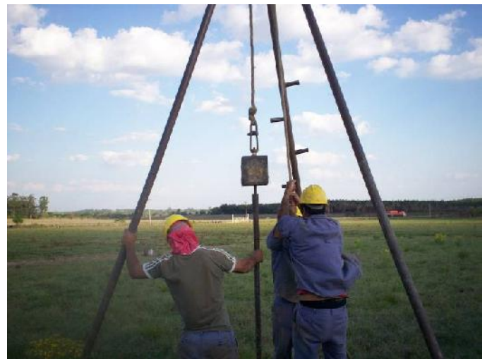
Fotos 3.1. Avance de perforación en tierra y ejecución de ensayo SPT.
