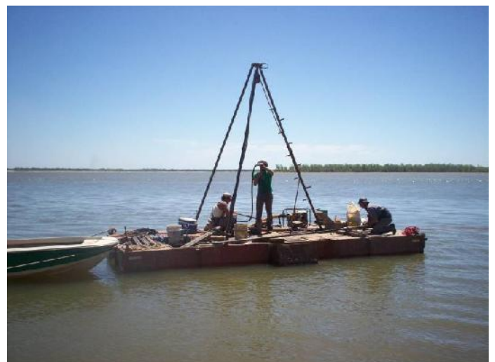
Fotos 3.2. Avance de perforación en agua y extracción de muestra.
