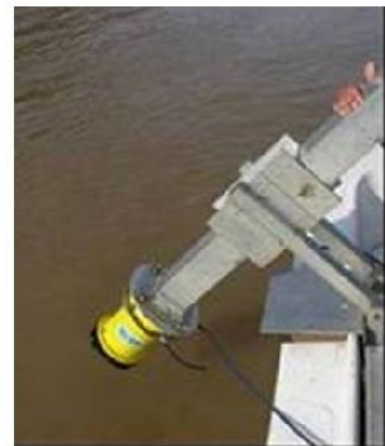
Fotos y Figura. 2.2. Perfilador Acústico Doppler.
