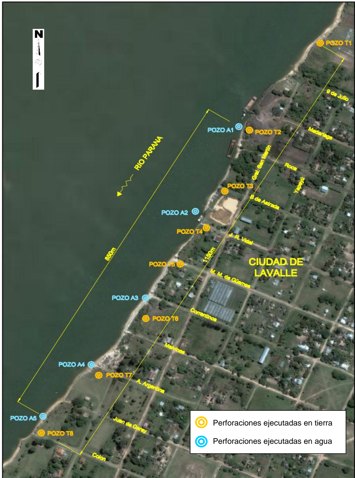
Figura 3.1. Ubicación de las perforaciones realizadas.
